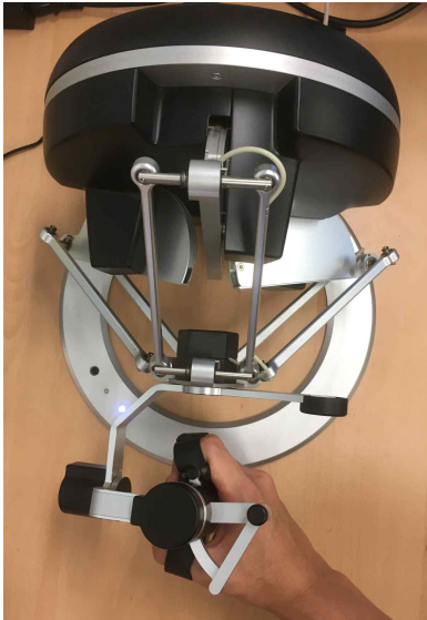
그림 1. 사용자의 입력부 (햅틱 장비) 예시 (Force Dimension 社의 Omega 7)
