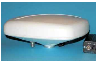
그림 2. UAV에 장착가능한 eLoran H-field 안테나 [3]
